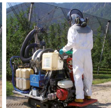
Applicazione dimostrativa con ugelli antideriva
