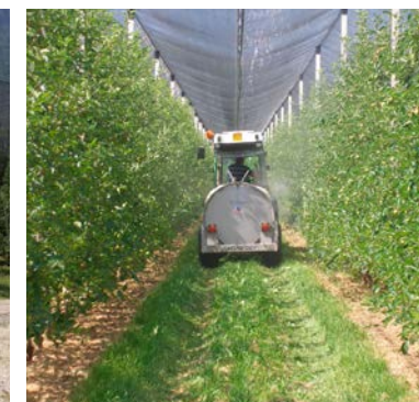
Applicazione con ugelli antideriva (lato sinistro) e convenzionali (lato destro) montati sulla stessa macchina
